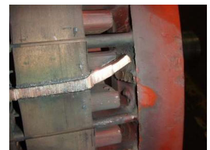
Figura 7 Rotor con una barra rota (Fuente: www.hecoinc.com)
